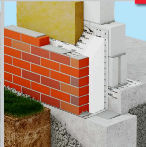
Im zweischaligen Mauerwerk auf Streifenfundament
