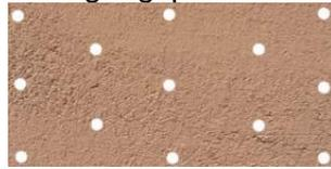
Decke: vollflächig + 15 Befestigungspunkte Achsmaß: 31,25 cm
