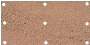
Decke: 12 Befestigungspunkte Achsmaß: 41,67 cm
