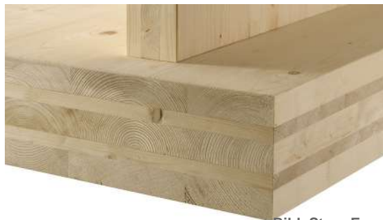
Abb. 14 Brettsperrholz folgt dem Prinzip des Sperrholzes. Die quer zueinander verlaufenden Brettlagen „sperren“ die holztypische Schwind- und Quellverformung auf 1/25.
