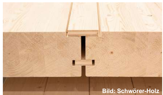
Abb. 12 Diese Deckenelemente aus Brettschichtholz gehören ebenfalls zur Kategorie Holzmassivbau. Das technische Prinzip lässt sich als „Brettstapeldecke“ beschreiben.
