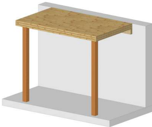
Abb. 32 Beispiel für eine zweiachsige Biegebeanspruchung ist ein Balkon. Während auf der Gebäudeseite die Brettsperrholzplatte auf einem durchgängigen Balken aufliegt, sind auf der Vorderseite nur zwei Stützen an den Ecken.
