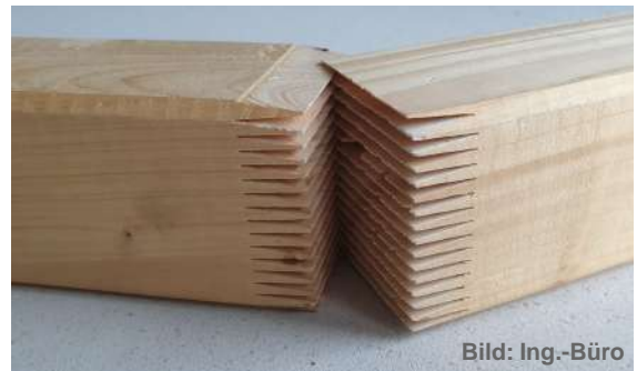
Abb. 11 Keilzinkenverbindung zum Fügen eines Endlosstranges
