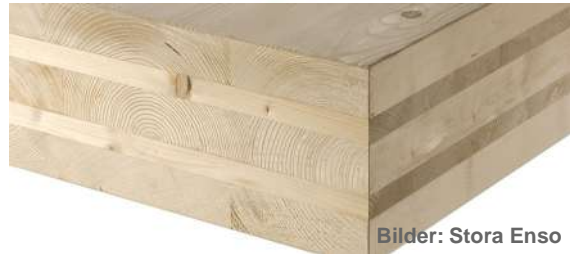
Abb. 15 Die Deckschichten der Elemente übernehmen die statische Hauptfunktion. Die mittleren Lagen sind statisch gesehen „Abstandshalter“ und bilden die Sperrlage (oben dreischichtiger und unten fünfschichtiger Aufbau).
