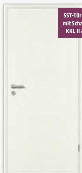
Schallschutz-Türblatt (SST) Schallschutz Klasse 1 (SD32 = Rw, P 32 dB) und Schall- schutzklasse 3 (HSD43 = Rw, P 43dB) mit Vollspanplatte (VSP) inkl. Schall-Ex, Bänder V0026WF, PZ vorgerichtet.
