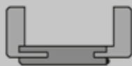
SCHIEFU-AL Zarge mit runder Futterplatte und Bekleidungen mit Rundkante (60 mm), ab Wandstärke 110: Verstellbereich -10/+10mm
