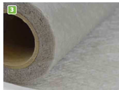
FILTERVLIES FIL 105 Zur Trennung der verschiedenen Schichten. Verhindert das Einschlammern von Feinteilen des Substrats in andere Ebenen
