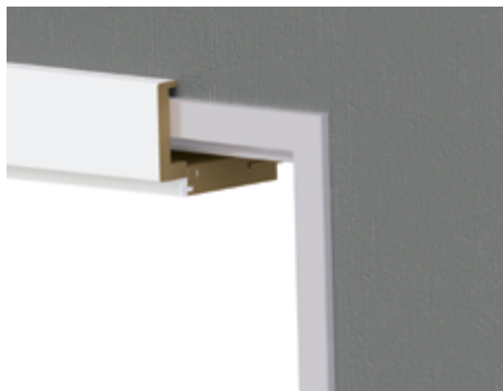
Die Konstruktion der Reno-Zarge ummantelt die alte Stahlzarge: Die schmale Bandtasche der Zarge verhindert Durchgangsverlust, die breite Bekleidung reduziert Nacharbeiten an der Wand.
