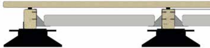
Bei geringen Aufbauhöhen müssen zusätzliche Lasten zwischen den Unterkonstruktionen eingebaut werden. Mit handelsüblichen Winkeln oder Systemen der Hersteller ist das einfach möglich.
