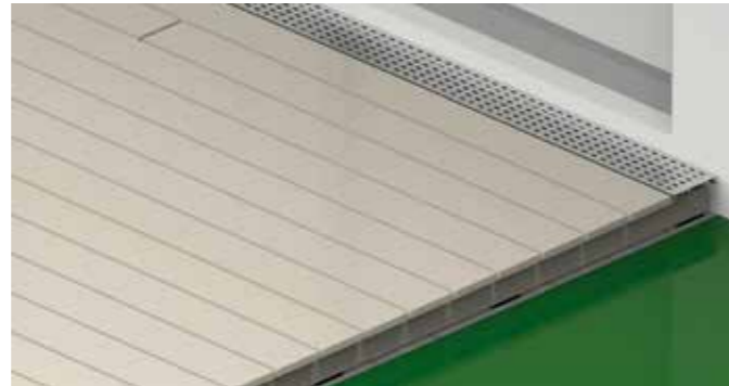
Bild 2. Verlegerichtung parallel zur Fensterfront mit einem Gefälle von 1-2 %.
