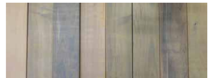
Die anfänglichen Farbunterschiede bei IPE gleichen sich später einigermaßen an.
