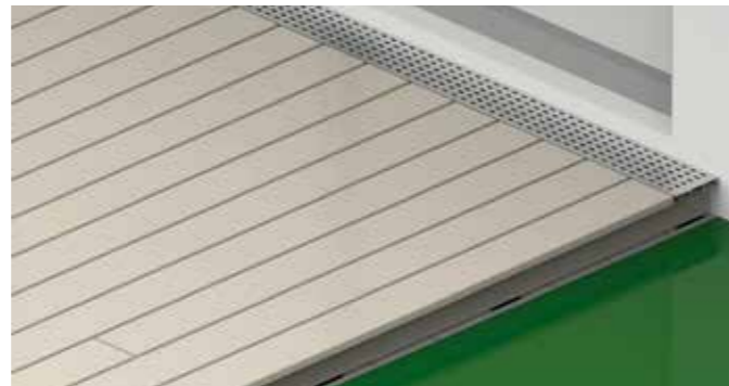
Bild 3. Verlegerichtung mit einem Gefälle von 1-2 % vom Haus weg.
