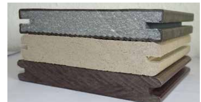
Vollprofile sind vorwiegend komplett durchgefärbt, bei co-extrudierten Profilen kann der Kern farblich unterschiedlich sein.
