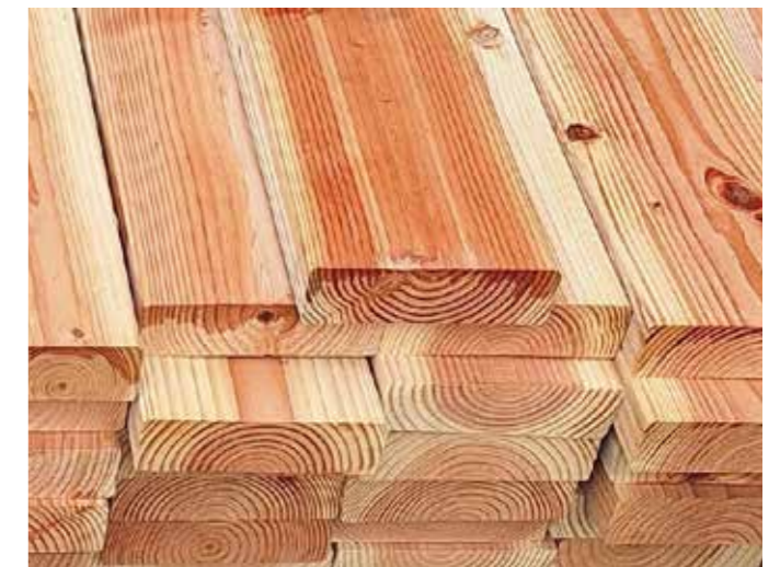
Der helle Bereich bei den Terrassendielen ist das Splintholz und der dunklere Bereich ist das Kernholz.
