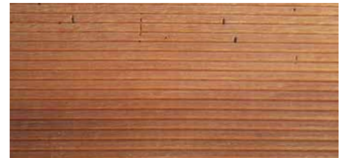
Kleine Löcher durch Insektenfräsgänge sind bei einigen Tropenhölzern normal und nicht vermeidbar.
